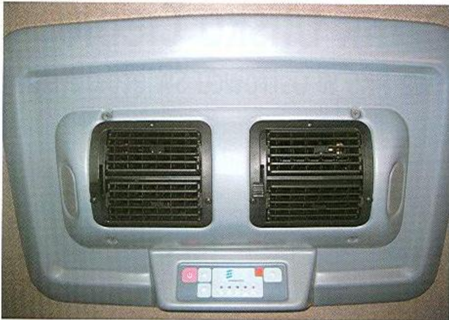
Nawiewy systemu Ebercool w kabinie kierowcy
