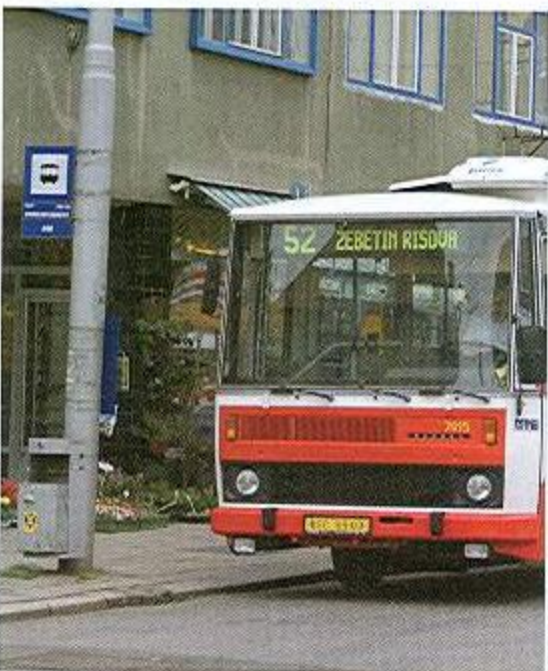
Przykład montażu Ebercoola w kilkunastoletniej Karosie B731
