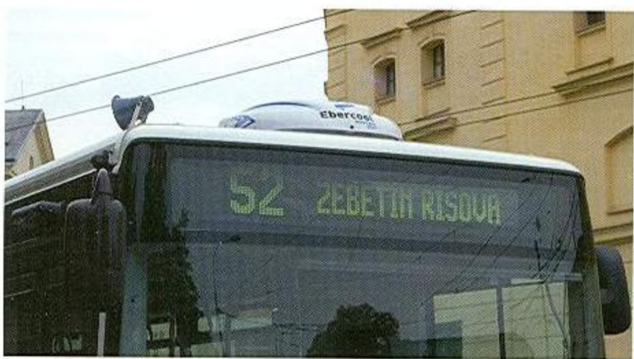
System Ebercool zamontowany na autobusie Irisbus Citelis należącym do DPMB Brno
